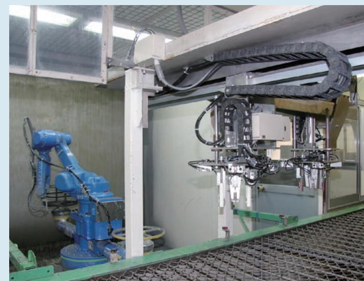
▲移載ロボットと塗装ロボット
