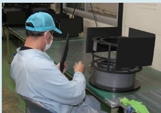
◀上塗り塗装前製品の的外観確認(必要に応じて研磨処理)
