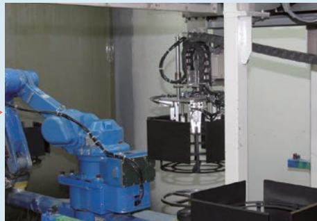
移載ロボットによりワークをロボット塗装ブースに移動させる
