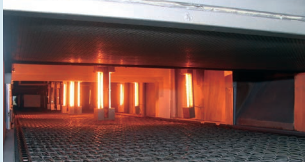
▲入口側から見た炉内(近赤外線点灯中)
