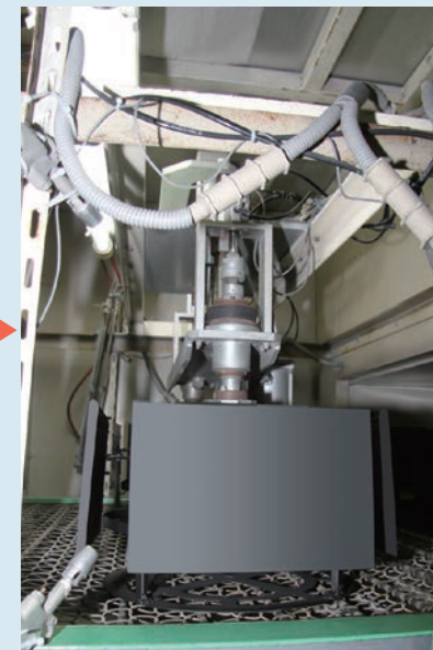
▲自動での除塵・除電ブロー(専用ジグごとワークを持ち上げて除塵・除電ブローを実施)▲
