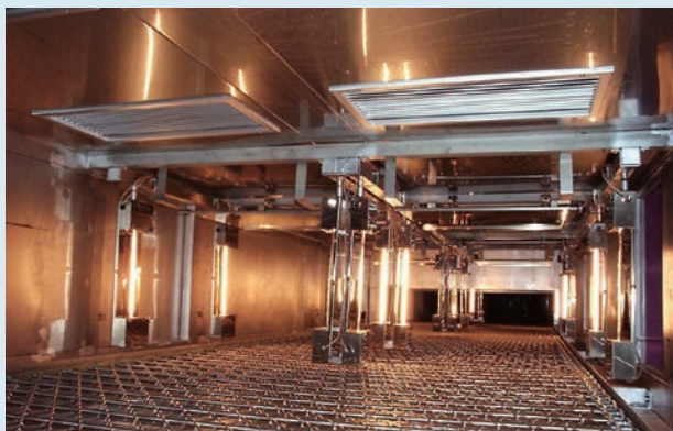
▲炉内循環はダウンフローによりゴミ・ホコリを制御
